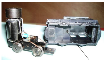
Aufbohren mit 2mm Bohrer
