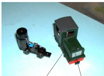
Aufbohren mit 2mm Bohrer von innen durch das Gewicht
