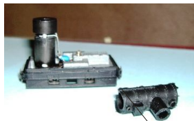
Stiftschraube mit Rahmen verschrauben
